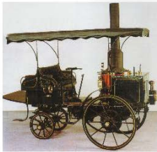
Четырёхколёсный «Тип II», созданный в 1855 году, был оснащён двумя паровыми машинами.
